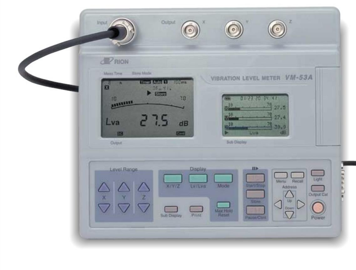
Vibration Level Meter VM-53/53A Twin Display
